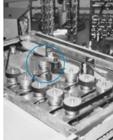
Transmisión por correa plana con Tensor SE y Rodillo R
